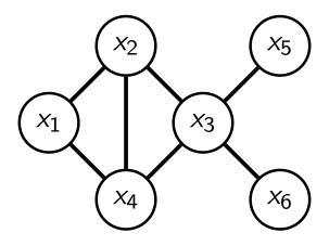
Maximal cliques:  $\{x_1, x_2, x_4\}, \{x_2, x_3, x_4\}, \{x_3, x_5\}, \{x_3, x_6\}$
