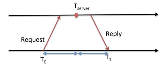
$$T_{\text{new}} = T_{\text{server}} + (T_1 - T_0)/2$$
