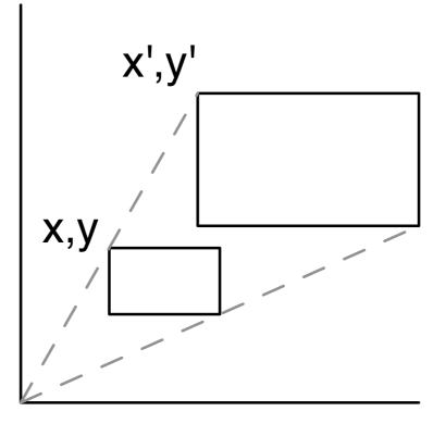
$$\begin{pmatrix} x'\\ y' \end{pmatrix} = \begin{pmatrix} s_x & 0\\ 0 & s_y \end{pmatrix} \begin{pmatrix} x\\ y \end{pmatrix}$$
