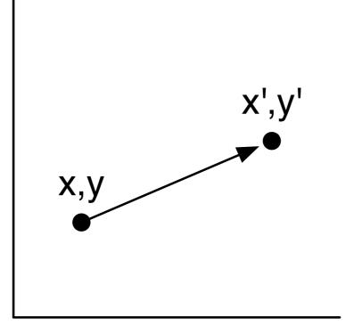
$$\begin{pmatrix} x' \\ y' \end{pmatrix} = \begin{pmatrix} x \\ y \end{pmatrix} + \begin{pmatrix} d_x \\ d_y \end{pmatrix}$$
